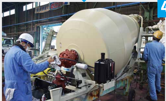
基台にドラムを架装し（載せ）、各部品を組み立てる作業員（写真上）。
