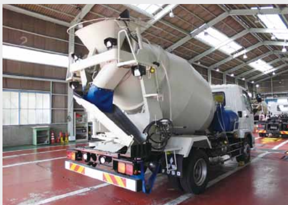
架装が終わり、計量を待つ生コン車（写真上）。
