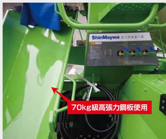
70kg 級の高張力鋼板を使用したシュート部分（写真上）。
