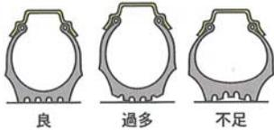
15-1. タイヤの接地部のたわみの状態により空気圧が不足していないか調べる。
